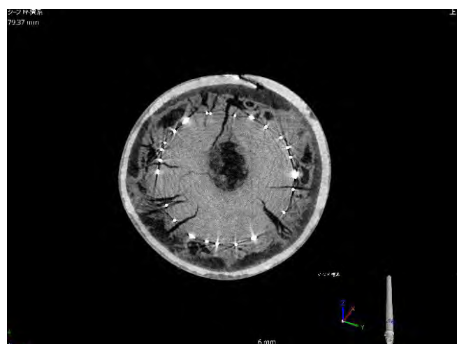
図5 鉄鋅・鍍着箇所の断面観察像
