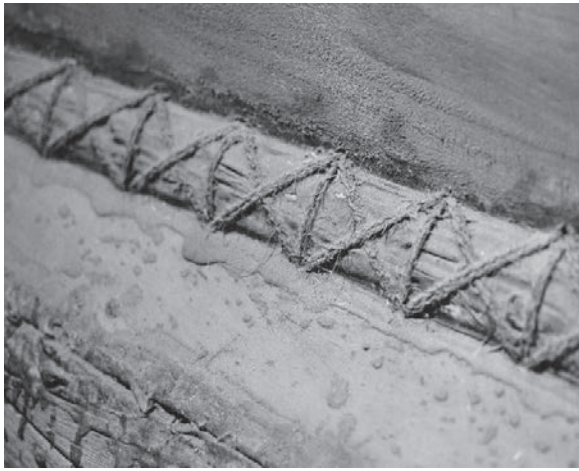
図8 伝統船舶の縫合の違い 左：インド洋 右：東南アジア(復元モデル)
